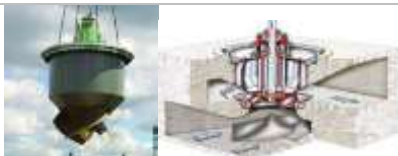
เครื่องสูบน้ำแบบแรงเหวี่ยงชนิดตัวเรือนคอนกรีต (Concrete Volute Pumps)
